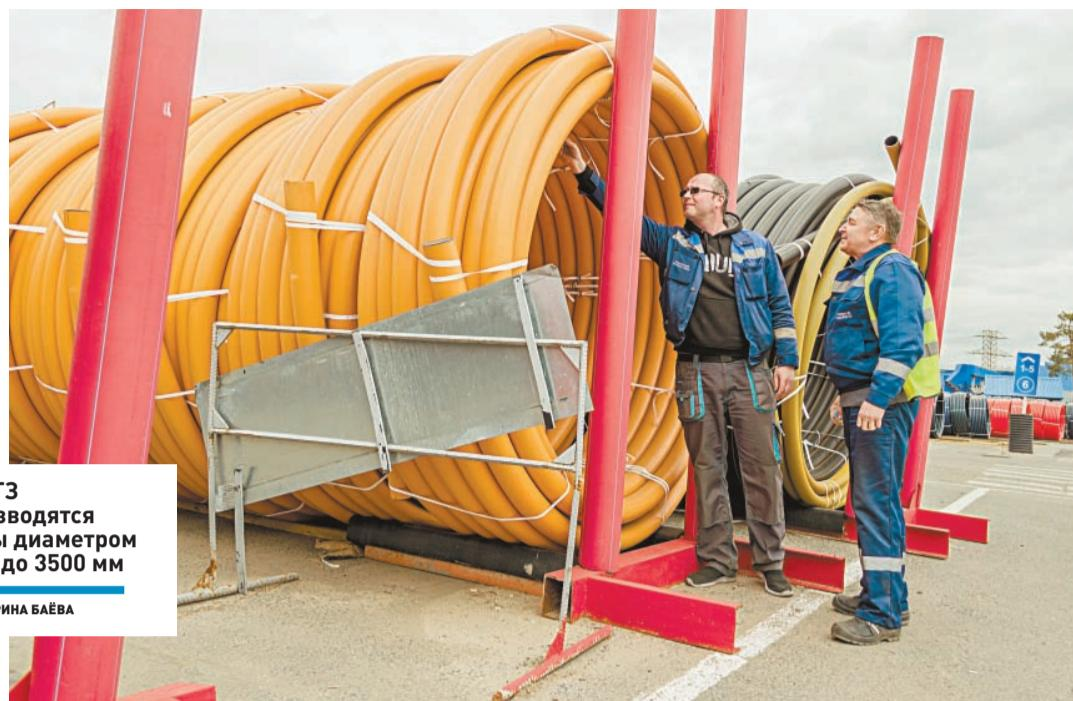
На КТЗ производятся трубы диаметром от 10 до 3500 мм
